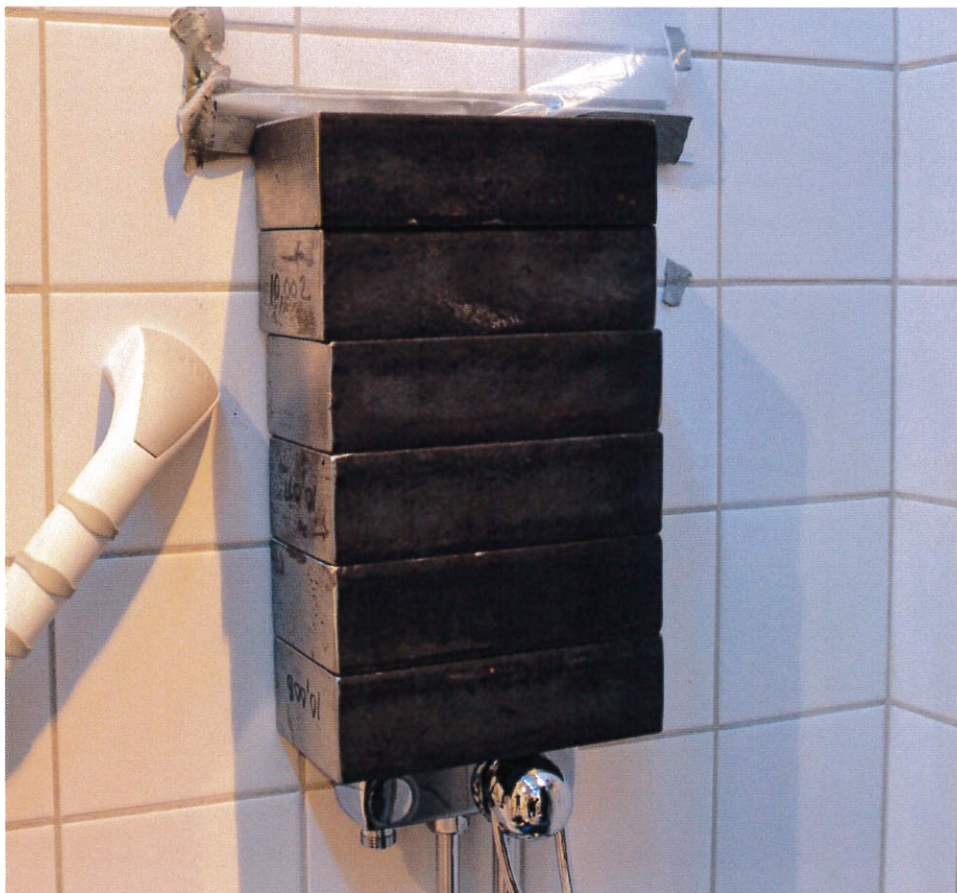
Bild 4. Belastning av badkarsblandare (60 kg).
