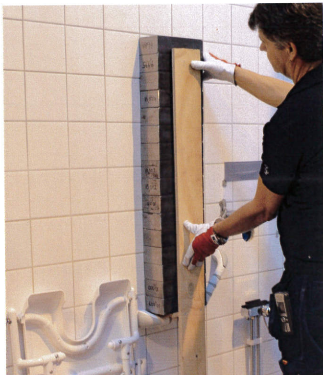
Bild 6. Belastning av vägghandtag (150 kg).
