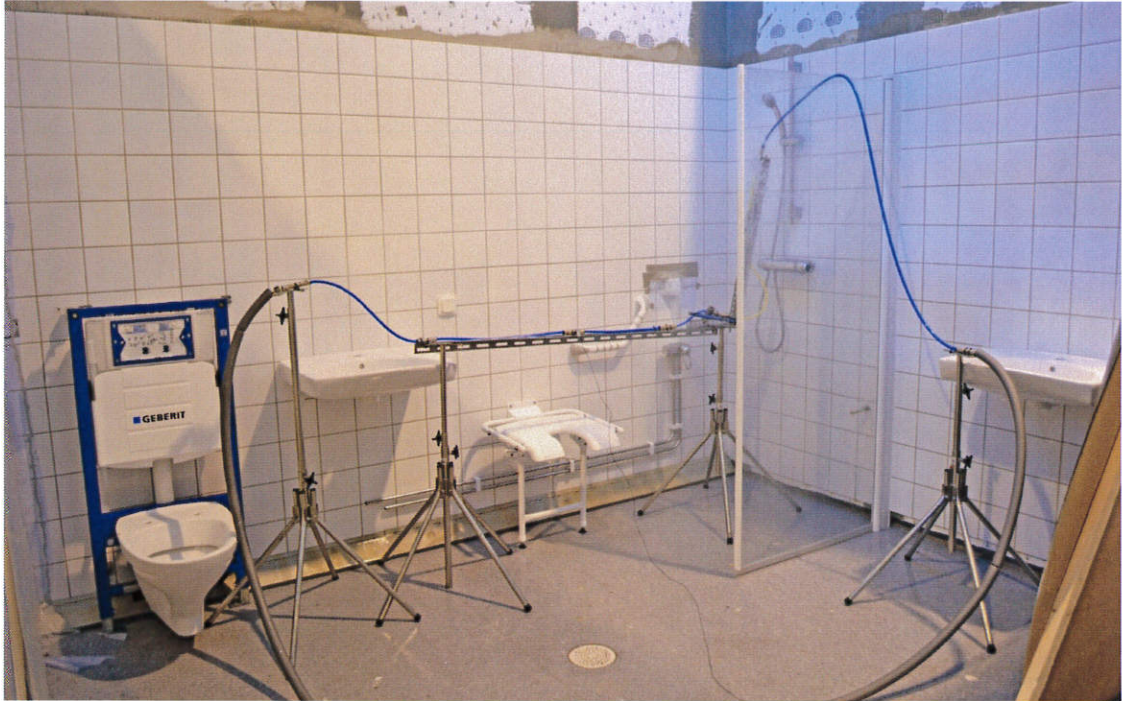
Bild 1. Provvupställning, prov 1, folie/kakel.
