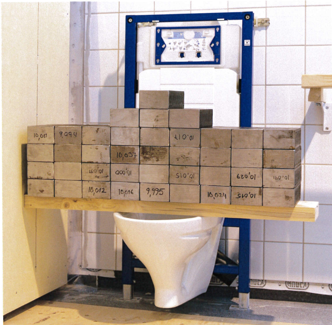
Bild 9. Belastning av WC-fixtur (409 kg).
