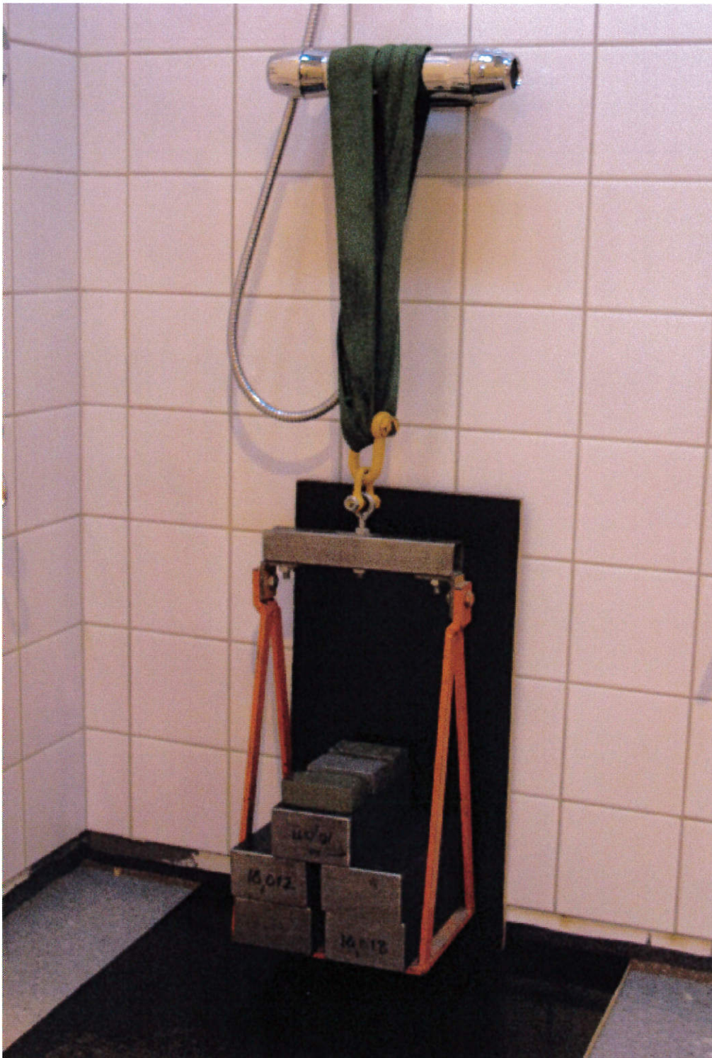
Bild 5. Belastning av duschblandare (60 kg)
