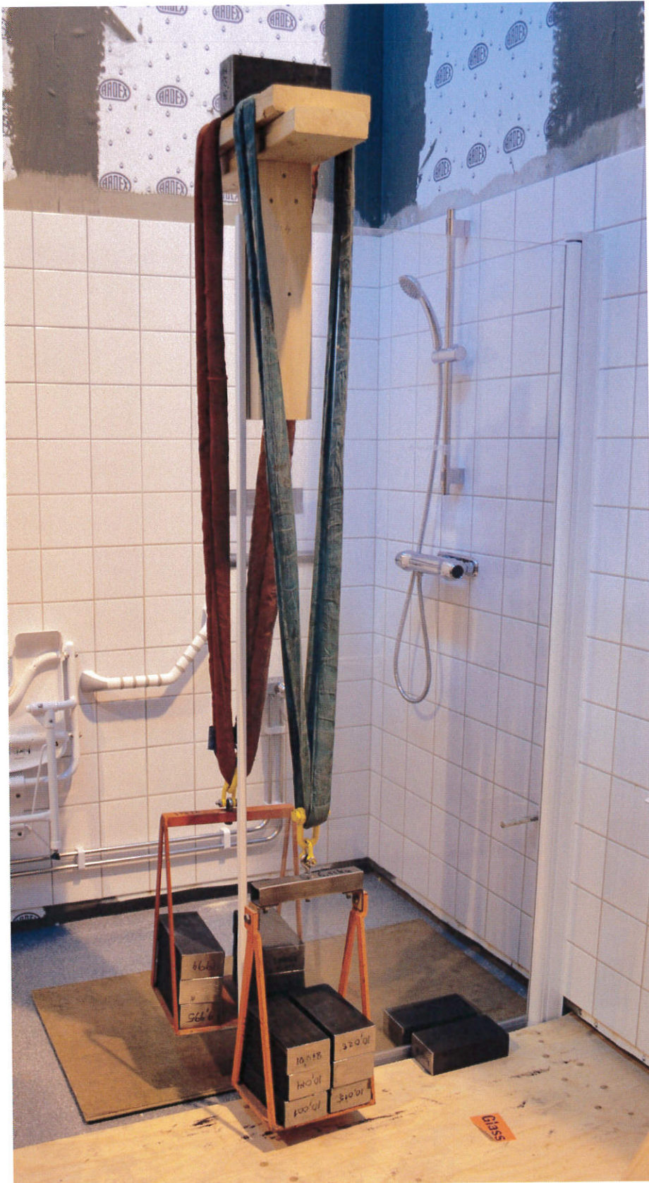
Bild 8. Belastning av duschvägg (150 kg).
