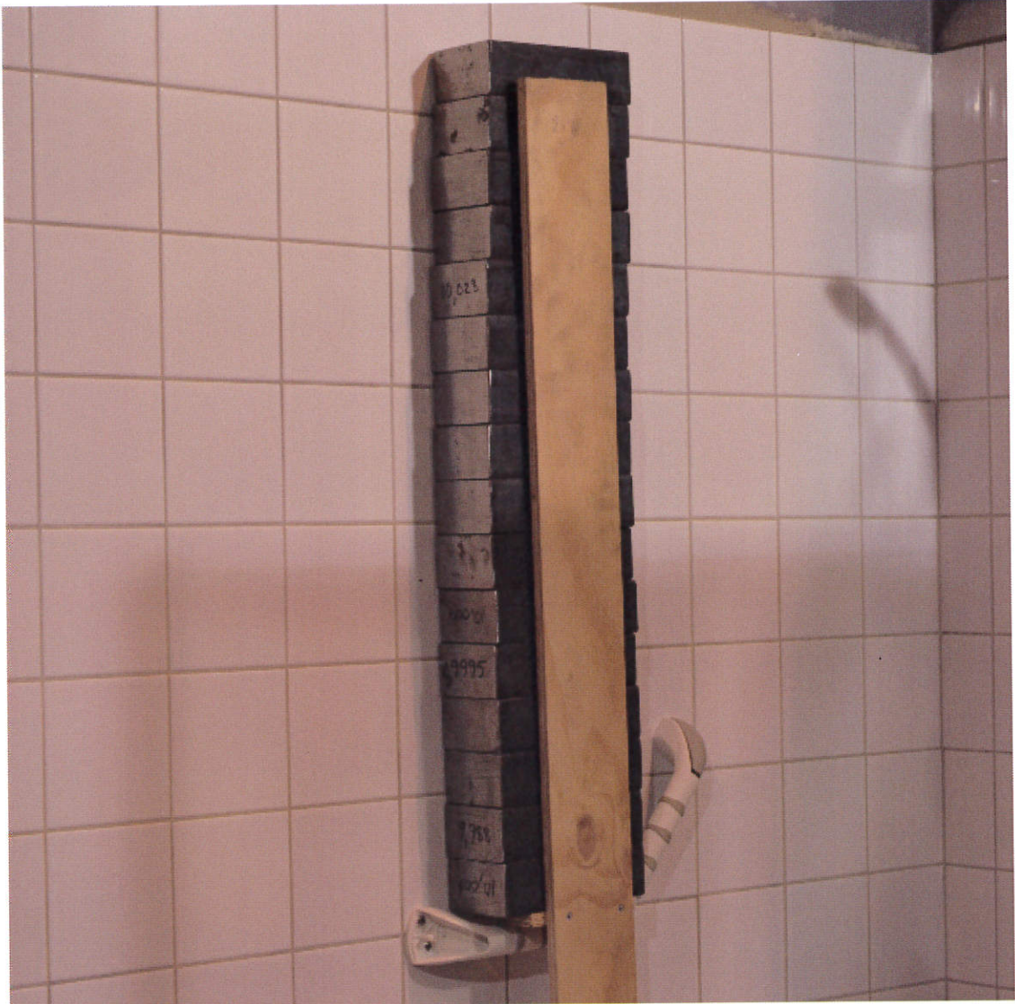
Bild 33. Vägghandtag under belastning (160 kg).
